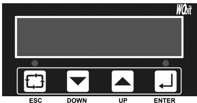
Rys. 6. Wygląd przodu zadajnika ZD100
